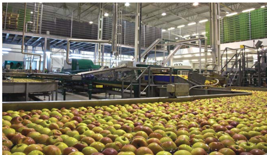
Maszyna wstępnego sortowania z wodnym rozładunkiem
