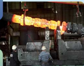
Odkuwka wału korbowego kuta metodą TR
